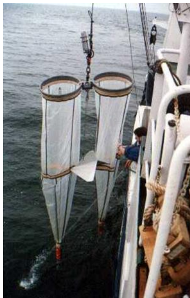
Fotografia 4.1.1.1. Siatka Bongo używana do poboru prób ichtioplanktonu
